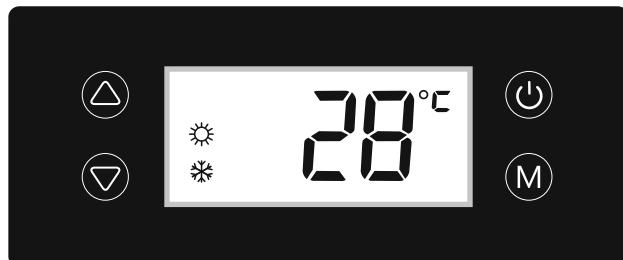
Gdy podgrzewacz basenowy pracuje lub jest w trybie gotowości, na wyświetlaczu pojawia się temperatura wlotu wody.
