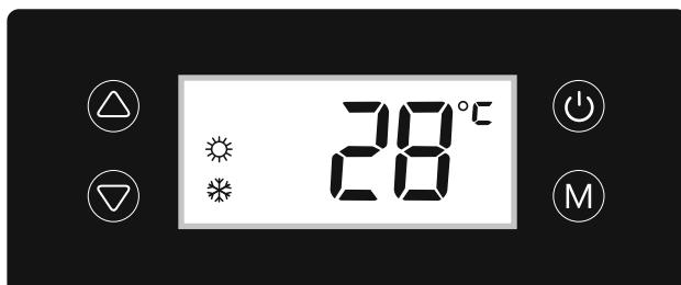
Quando il riscaldatore della piscina è in funzione o in standby, il display mostra la temperatura dell'acqua in ingresso.
